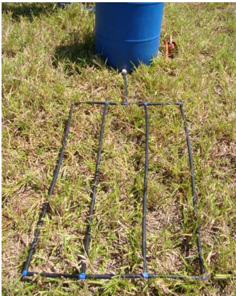
Figura 02: Detalhe da montagem do sistema para pré molhamento
