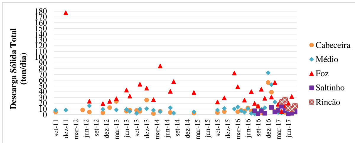
Figura 07. Descarga sólida total observada nos diversos cursos de água da bacia.
